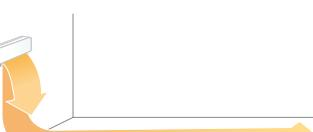
Заслонка закручивает поток воздуха вниз, обеспечивая более эффективный обогрев
